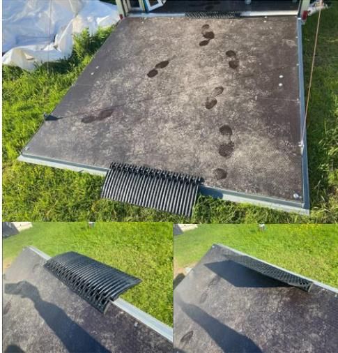
Des rampes pivotantes ont été installées sur la porte arrière pour faciliter les déplacements avec les chariots sur roues.
