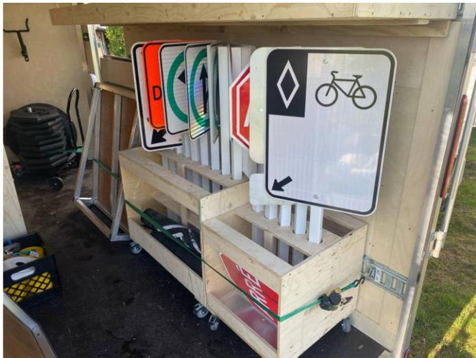
Installer les chariots pour panneaux de signalisation côte à côte. Passer une sangle d'un côté à l'autre avec la sangle à cliquet et resserrer.
