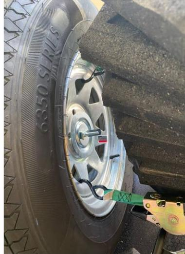
Pour l'arrimage du support à peser, il faut l'arrimer au pneu de secours avec la sangle à cliquet à l'avant de la remorque.
