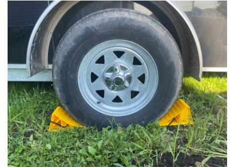
Les cales de roues doivent être installées lorsque la remorque est stationnée sans être arrimée à un véhicule.
