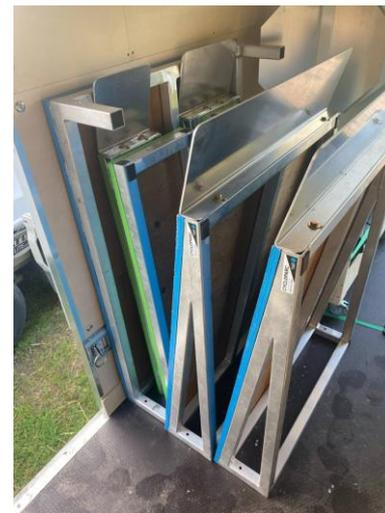
4. Installer les deux modules bleu face plate vers l'intérieur de la remorque.
